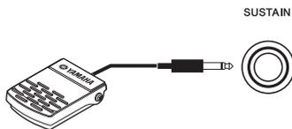
Sie können ein natürliches Ausklingen erzeugen, indem Sie während Ihres Spiels den mitgelieferten Fußschalter betätigen, der an der [SUSTAIN]-Buchse angeschlossen ist. An diese Buchse können Sie auch ein optionales Fußpedal FC3A oder einen Fußschalter FC4A oder FC5 anschließen. Mit dem FC3A können Sie die Haltpedal-Funktion nutzen.
